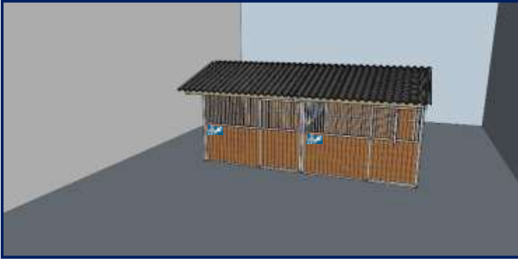
Stap 9.0: Het plaatsen van de golfplaten.
