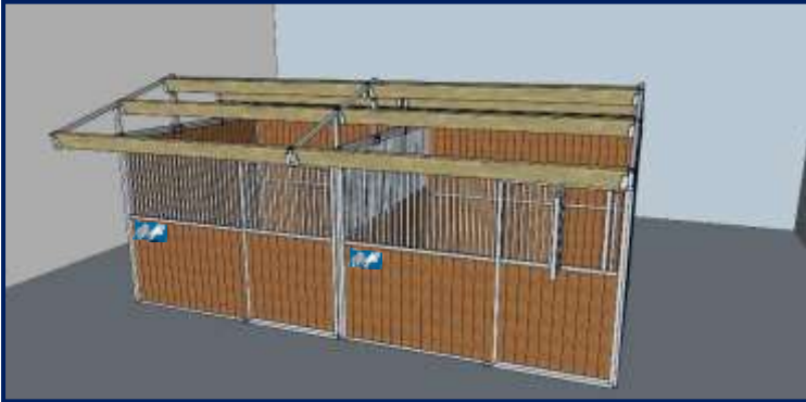
Stap 8.0: Het plaatsen van de balken.
