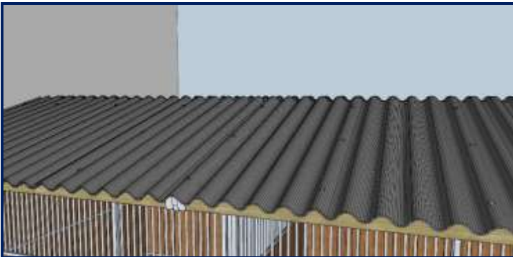
Stap 9.1: Elke plaat wordt eerst vastgezet met 4 golfplaatbouten, deze worden geschroefd in de onderste en middelste balk. De laatste golfplaat wordt bevestigd met 6 golfplaatbouten. Wanneer de afdekkap wordt bevestigd worden de laatste schroeven geschroefd.
