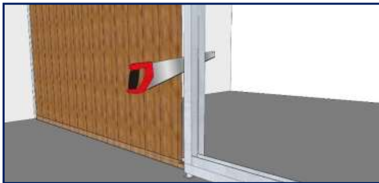
Stap 11.1: Zaag van de een na laatste plank de veer eraf.
