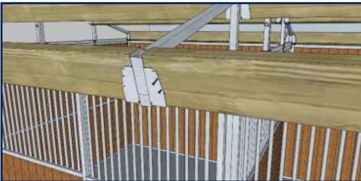
Stap 8.1: Aan beide kanten van de balk worden 2 schroeven geplaatst. Deze worden door het balkschoentje vastgeschroefd in de balk.
