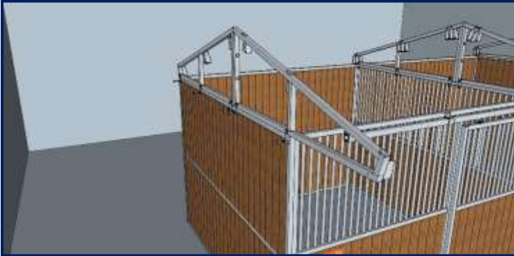
Stap 7.0: Het bevestigen van de spanten op de wand.
